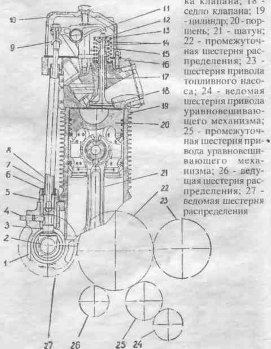
Рис. 8. Механизм газораспределения дизеля Д-21А1: 1 - блок-картер; 2 - распределительный вал; 3 - толкатель клапана; 4 - валик декомпрессора; 5 - втулка толкателя; 6 - уплотнительное кольцо; 7 - штанга толкателя; 8 - кожух штанги; 9 - регулировочный винт; 10 - крышка клапанов; 11 - коромысло клапана; 12 - тарелка клапана; 13 - сухарь клапана; 14 - пружины; 15 - клапан; 16 - головка цилиндра; 17 - втулка клапана; 18 - седло клапана; 19 - цилиндр; 20 - поршень; 21 - шатун; 22 - промежуточная шестерня распределения; 23 - шестерня привода топливного насоса; 24 - ведомая шестерня привода уравнивающего механизма; 25 - промежуточная шестерня привода уравнивающего механизма; 26 - ведущая шестерня распределения; 27 - ведомая шестерня распределения
