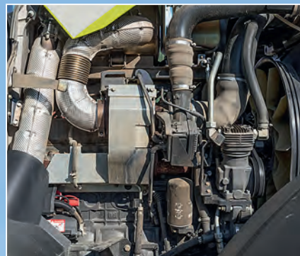
A turbófeltöltő hővédő pajzsát egy speciális ellenőrzés részeként kicserélték.
