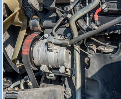
A hűtőventilátor meghajtó ékszíjait zajt adtak, és 1000 óra elteltével cserélték őket.
