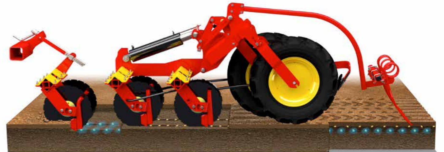
A Rapid elv azt jelenti, hogy minden egyes tömörítő kerék az előtte futó egy pár vetőcsoroszlyát vezérel egy rudazaton keresztül. Ez a megoldás garantálja, hogy nagy menetsebesség esetén is állandó marad a vetési mélység.
