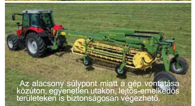
A kosarak központi csapos függesztése egyenetlen területen is tiszta terményt biztosít
