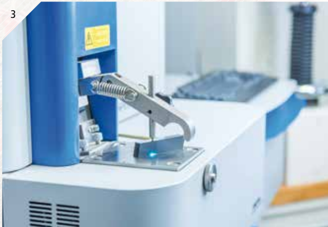
3. Szikraspektrometrikus elemzés: Ezt követően a szikraspektrometrikus elemzés által a minta anyagának összetétele kerül meghatározásra.
