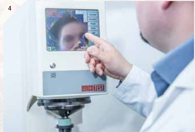
4. Rockwell, Vickers vagy Brinell módszer szerinti keménységvizsgálat: A vizsgálandó anyag (acél, öntvény, alumínium, stb.) és a vizsgálati megbízás ( keménység változása, szegélyrétegek keménységének változása, stb.) függvényében történik a megfelelő keménységvizsgálat kiválasztása.
