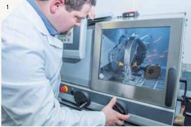
1. Vágás: Teszt kezdetén az anyagminták előállítására. A próbatestek a meghatározandó tulajdonságoknak megfelelően előkészítendőek. Először speciális vágó segítségével a „vágás” történik.
