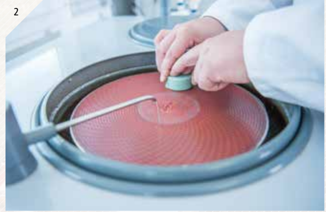
2. Kőszőrülés, polírozás: A próbatest beágyazásához kőszőrülés és polírozás szükséges. Így a szükséges felületi minőség hozható létre.
