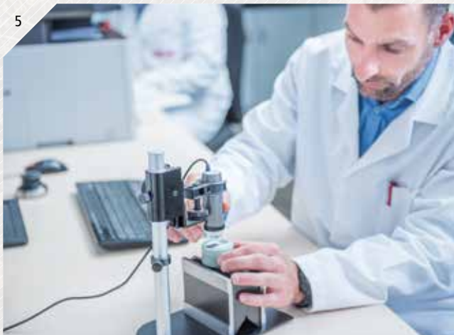
5. Szerkezeti elemzés: A szerkezeti megítélés végrehajtása érdekében a maratás történik. Ezt követi a minta mikroszkópikus elemzése és vizsgálata.
