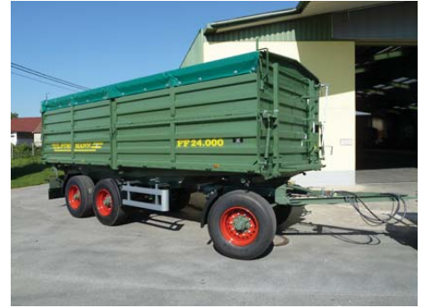
3-Achs-3-Seitenkipper 24t - 40 km/h 7,5 x 2,48 x 1,6m
