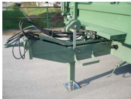
Mechanische Sattelstützwinde mit 2 Geschwindigkeiten
