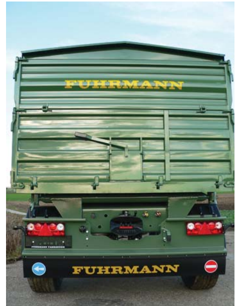
Heckansicht 2-Achs 3-Seitenkipper 18t (40 km/h)
