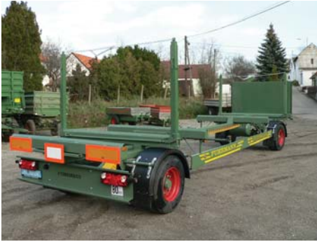
2-Achs-Rungenwagen 13t - 80 km/h mit ausziehbarem Fahrgestell
