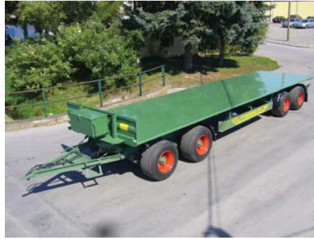
4-Achs-Plateauanhänger 32t - 40 km/h 10,0 x 2,55m
