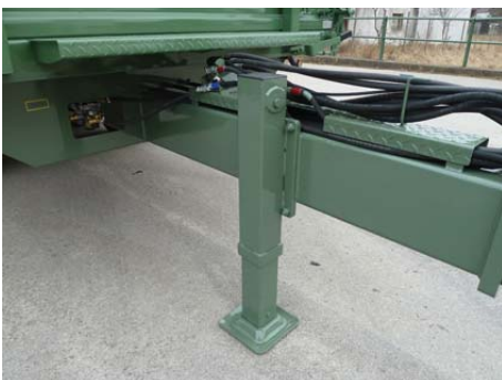
Hydraulischer Stützfuß doppelwirkend (Rohr in Rohr)
