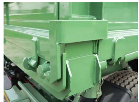
Fanghaken seitlich Pendelwand hinten (ab 5,15m)
