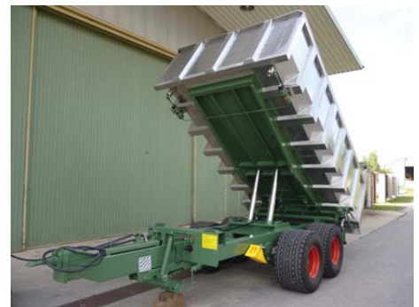
Tandem-Rückwärtskipper 15t - 25 km/h 4,14 x 2,48 x 1,0m Nirosta-Wanne
