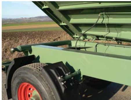
Hauptrahmen + Kipplagerung 2-Achs-3-Seitenkipper 18t
