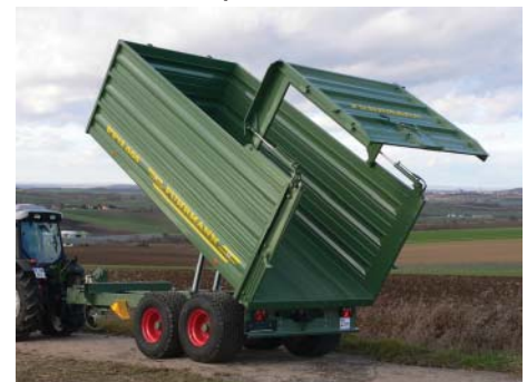
Hydraulische Rückwandöffnung mit mech. Verriegelung
