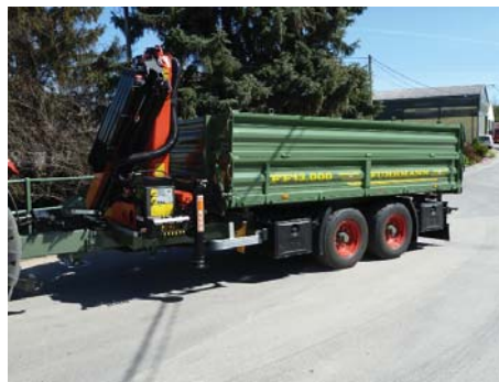
Tandem-3-Seitenkipper 13t - 40 km/h 4,55 x 2,35 x 1,0m mit Kranaufbau
