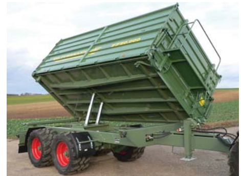
Haupt- Kipprahmen Tandem-3-Seitenkipper 20t
