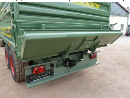
Hydraulische Heckklappe doppelwirkend 400 mm hoch
