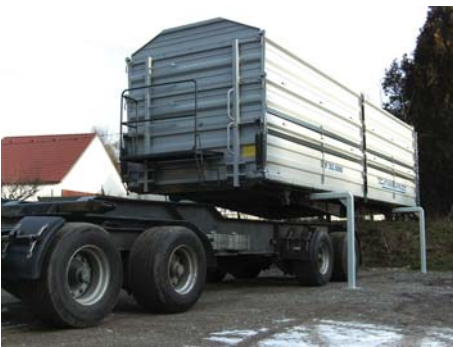
4-Achs-3-Seitenkipper 32t - 40 km/h 8,5 x 2,48 x 2,0m mit konischer Brücke und Wechselaufbausystem
